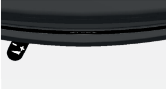
Verbrandingslucht volledig gesloten, hendel uiterst links
