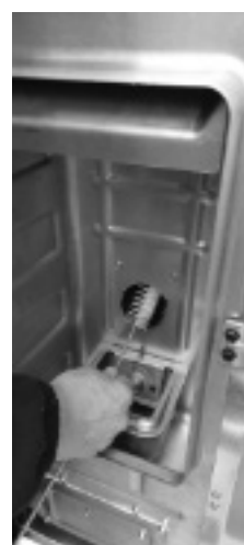
Fig. 35 - Reiniging met flessenwisser
