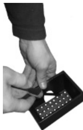
Fig. 33 - het schoonmaken van de vuurpot
